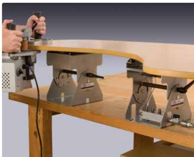
Spannen eines großen Werkstücks mit dem Zusatzmodul SVN470 und dem Vakuumsystem SVN450.
