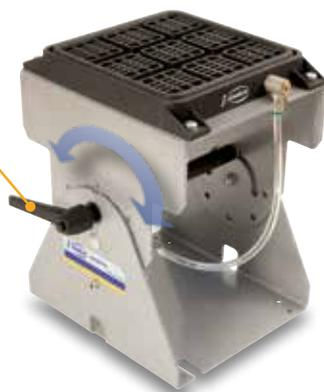
Das SVN470 Zusatz-Vakuumsystem besteht aus einem Vakuumpad SVN250, der an ein schwenkbares Haltesystem angebracht ist. Das SVN470 Vakuumsystem ermöglicht ein variables und sicheres Arbeiten. Das System beinhaltet einen Schnellanschluss für einen Druckluftschlauch. Im Lieferumfang ist eine Spannzwinde enthalten, um das System schnell befestigen zu können sowie ein Set mit Dichtungsgummis in verschiedenen Größen. Befestigungsschrauben für ein SVN250 haben die Artikelnummer 0999102.
