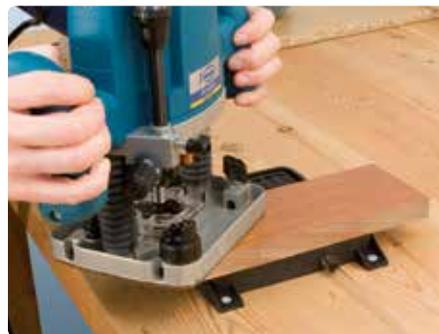
Spannen kleinerer Werkstücke durch Verkleinerung der Spannfläche mit den mitgelieferten Dichtungsgummi.
