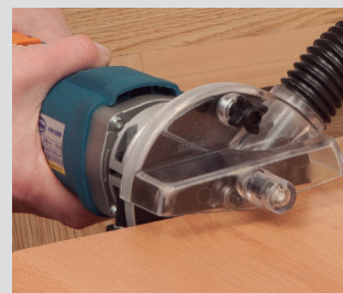
Fräsvorsatz rund (Sonderzubehör) mit Gleitplatten für verschiedene Fräserdurchmesser (Ausparung D=20, 30 mm).
