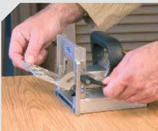
Winkel und Höhe können am Frontteil beliebig eingestellt werden
