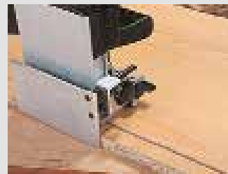
Seitenanschlag CB64B: Fräsen von Fußleisten zum Anpassen an den Parkettboden
