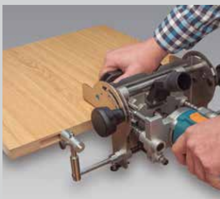
Fräsen bei 90° mit verstellbarem Anschlag
