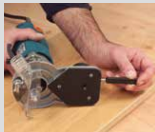
Einfache Verwendung des Hilfsanslags für die Eckenbearbeitung
