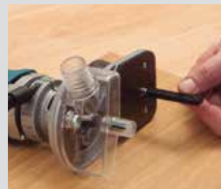
Einfache Verwendung des Hilfsanslags für die Eckenbearbeitung
