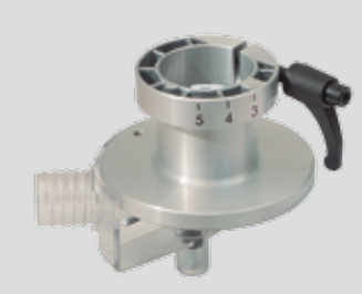
Fräsvorsatz rund (Sonderzubehör) mit Gleitplatten für verschiedene Fräserdurchmesser (Ausparung D=20, 26, 30 mm)
