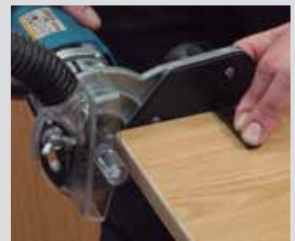
Sichere Auflage für präzises Arbeiten mit dem Hilfsanslag
