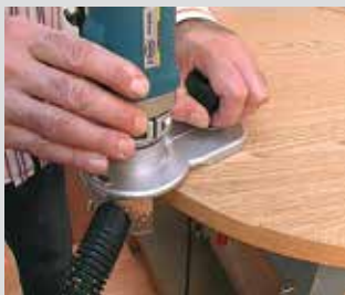
Fräsen der Längskante - Kombifräsvorsatz mit großer Auflagefläche
