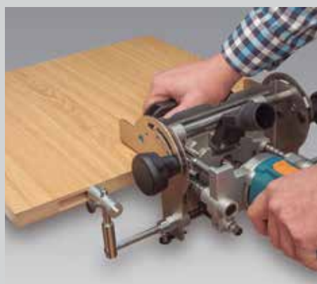
Fraisage à 90° en utilisant guide
