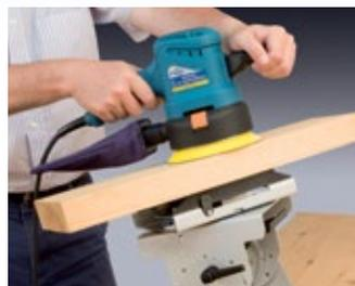
Dreh- und schwenkbares Haltesystem.
