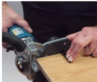
Präzise Führung für das Eckenfräsen (5600060)
