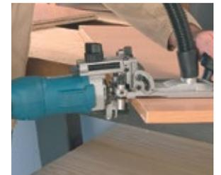
Fräsen der Kante mit dem geraden Fräser.
