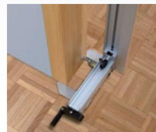
Praktisches System zum Fixieren der Maschine am Rahmen und zum Einstellen der Schnittbreite.
