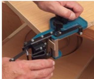
Das Schneiden an beiden Enden der geraden Platte
