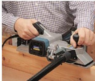
Absaugstutzen zum Anschluss einer externen Absaugvorrichtung.
