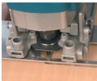
Führungsring zum Kopieren mit Schablone als eine kleine Oberfräse.
