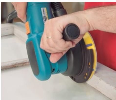
Der 5 mm Schleifhub garantiert hochwertige Schleifergebnisse auch beim Polieren und Schleifen von Lacken.
