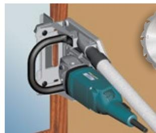
Zurichten von Holzfensterrahmen. Führung auf dem verstellbaren Frontführungsrahmen.
