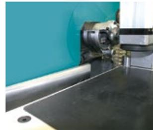
Führungsanschlag an der Seite des zu fräsenden Umleimers.
