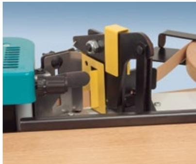
Automatischer hinterer Bandschnitt. Fußpedal für Geformte oder runde Werkstücke.
