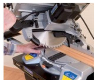
Sehr komfortables Arbeiten beim Schneiden langer Teile dank den verstellbaren Auflagerrollen auf beiden Seiten.
