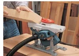
Stationäreinrichtung zur Verwendung des Hobels auf einer Werkbank (Sonderzubehör).
