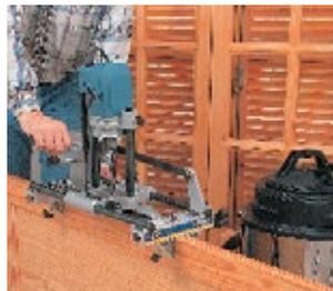
Die Maschine kann auch in der Horizontalen arbeiten. Besonders nützlich, wenn eine Serie von Langlöchern in ausgehängten Türen hergestellt werden soll.
