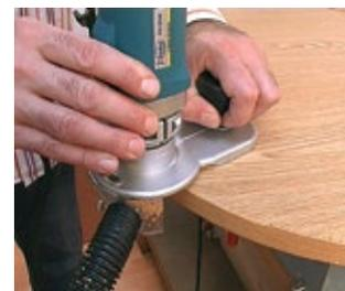
Der Fräskopf CA56U ermöglicht ein unterbrechungsfreies Fräsen der vier Kanten einer Platte. Die Fräse hat eine große Auflagefläche und einen zusätzlichen Halteknopf für perfekte Stabilität.
