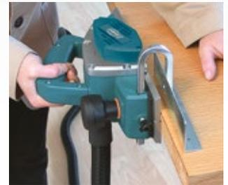
Seine Vielseitigkeit macht es möglich, den Hobel für verschiedene Arbeiten einzusetzen. Dank des Schleifzylinders können die Enden an Türen und Regalen ohne Aussplittern geschliffen werden.
