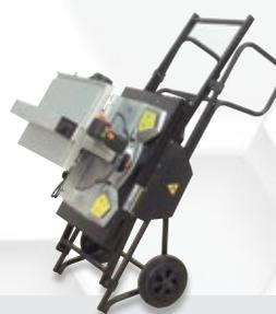
Der MT58K kann mit montierter Maschine transportiert werden.
