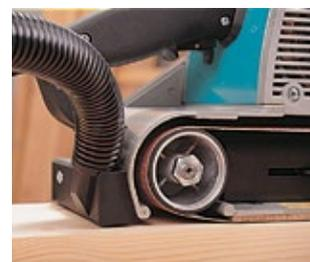
Äußerer Anschluß für die Staubabsaugung; Verbindung zur Staubabsaugung mit der Standard-Staubabsaugvorrichtung (zusätzlich).
