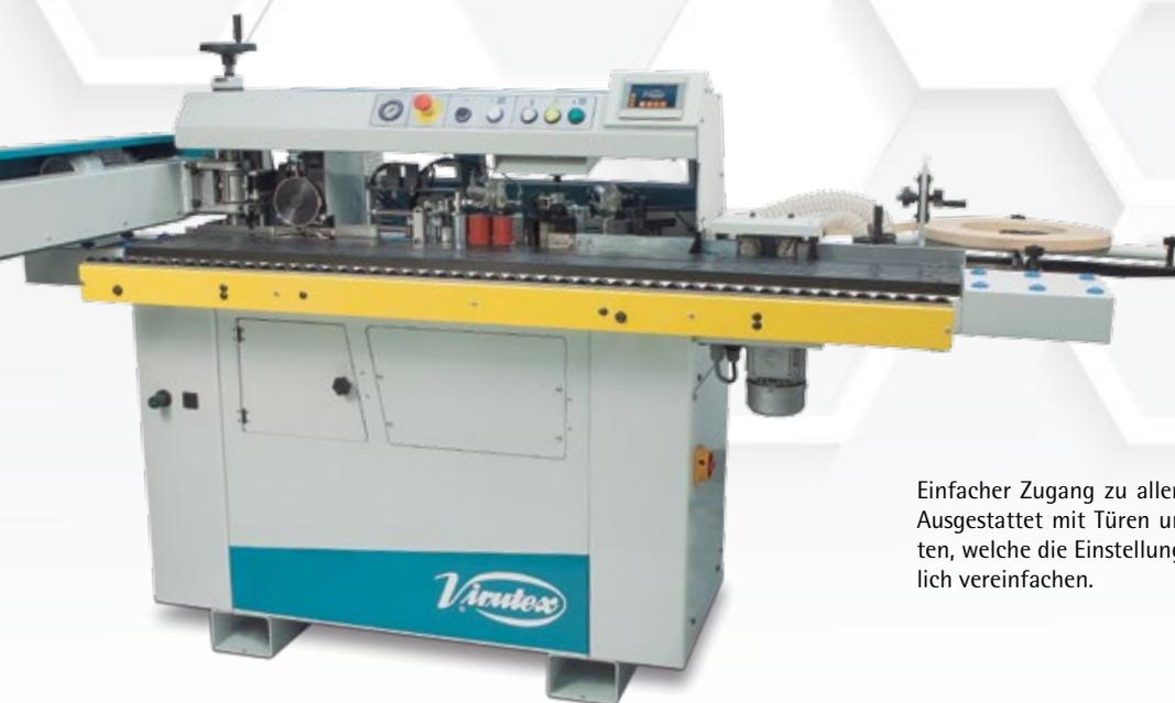
Einfacher Zugang zu allen Maschinenelementen. Ausgestattet mit Türen und beweglichen Einheiten, welche die Einstellung der Maschine wesentlich vereinfachen.
