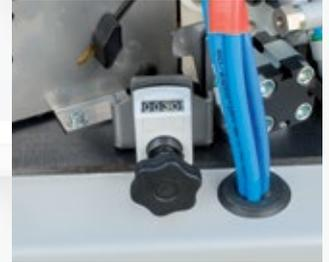
Einstellung für Bandstärke, Aufnahmeführung und Verleimrolle mit einem einzigen Verstellknopf mit Maßanzeige.
