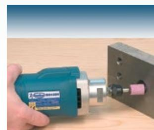
Man kann raue Oberflächen und auch Bohrungen (entgraten) fertig bearbeiten. (Schleifwerkzeug ist nicht Standard Zubehör)
