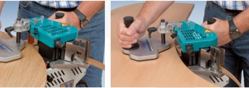
Führungshalter bis zu 10° neigbar zum Aufleimen von Türenkanten.
