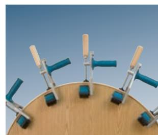
Fixierung vom Kantenschutz an konvexen Platten
