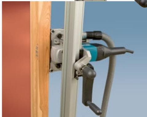
Sauberer Schnitt, so dass der neue Rahmen direkt an dem alten befestigt werden kann.
