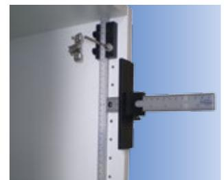
Bohren für das Anbringen unsichtbarer Scharniere.
