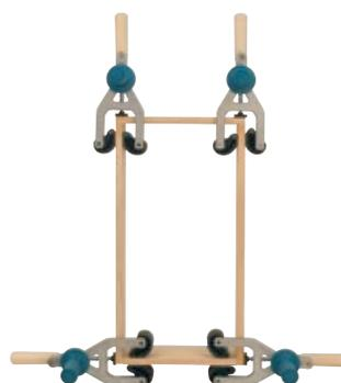
Kantenzwinge zur Fertigung von Schubladen.
