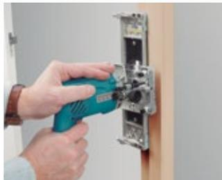
Frässhuh mit Millimetereinstellung ermöglicht perfekte Aussparungen für Beschläge.
