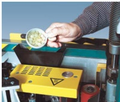
Leicht durch speziellen Ablassstutzen zu entleeren. Ohne auszubauen kann man den Tank während der Arbeit mit Leim befüllen ohne die Maschine auszuschalten
