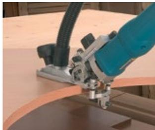
Kopierer mit Kugellager. Perfekte Führung an geraden oder gekrümmten Oberflächen.
