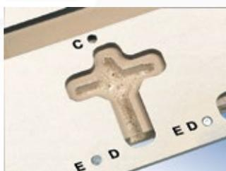
Kreuzformfräsen zum Verbinden beider Seiten der Arbeitsplatte.
