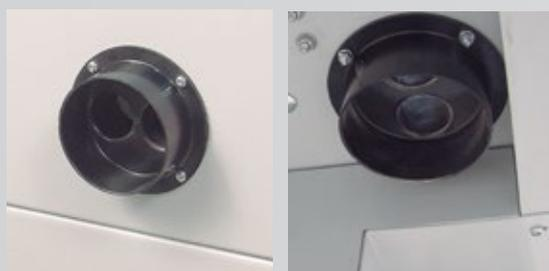
Anschluss für Staubabsaugung mit 100 mm Durchmesser. Die Mindestluftleistung der Absaugung sollte 1000 m<sup>3</sup>/h betragen.
