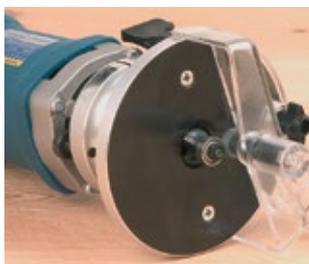
Spezielles Bremssystem für das Kugellager des Fräasers, wodurch vermieden wird, dass er bei Beginn der Arbeiten die Platte beschädigen kann.
