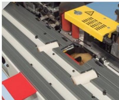
**Angetriebene Vorschubeinheit.** Optimale Füllmenge vom Leimtank. Leicht auszubauen und zu pflegen. Leicht zu entfernen und dank der Teflon® Beschichtung auch leicht zu reinigen.
