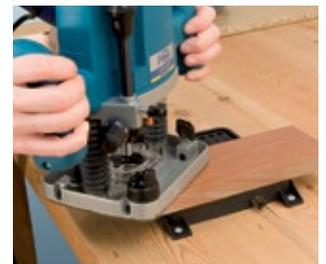
Das Halten kleiner Werkstücke ist an einem Abschnitt der Saugplatte möglich.
