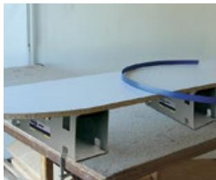
Mit Hilfe zweier Vakuumsauger ist es möglich, größere Platten zu halten.
