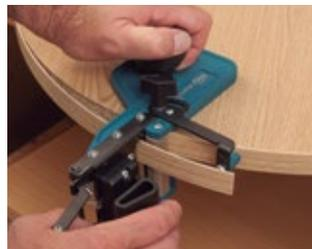
Das schneiden des Überstandes bei runden Platten.
