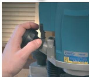
Hauptschalter und Kopfsperre können vom Handgriff aus bedient werden, dadurch vollständige und gefahrloses Arbeiten mit der Maschine.
