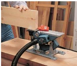
Stationäreinrichtung zur Verwendung des Hobels auf einer Werkbank (Sonderzubehör)..
