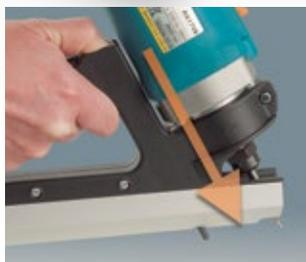
Mit Führungszapfen; für ein einfaches Einfräsen zu Beginn des Nutvorganges.
