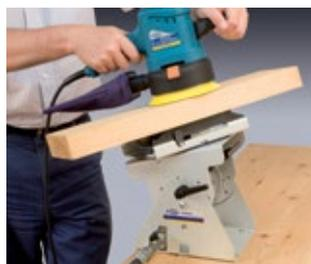
SVN460 schwenkbar und drehbar.
