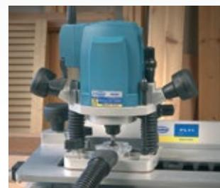
Hauptschalter und Fräskopfklammer können vom Handkopf aus bedient werden.
