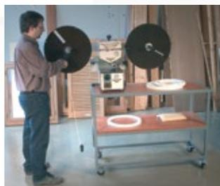
Einfach zu handhaben und zu starten; ermöglicht ein unkompliziertes Vorleimen von Rollen.
