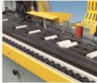
Zwei Zusatzrollen und das Andrucksystem am Vorschubtisch sorgen für den optimalen Anpressdruck der Kante an die Platte.
