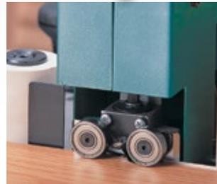
Kraftvolle Kantenfräseinheit fräst automatisch mit einem Radiusfräser  $r=3 +10^\circ$  beide Seiten
