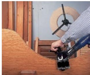
Ermöglicht das Kantenleimen von runden oder geformten Werkstücken.
