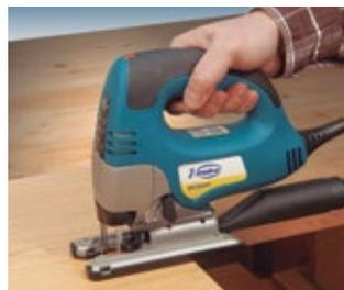
Präziser ausrissfreier Schnitt
