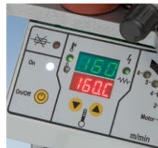
Temperatureinstellung (120°-200°C) wird von einem Mikroprozessor für hohe Exaktheit und Genauigkeit überwacht. Die Temperatur steigt durch Stromimpulse damit das Heizelement geschützt bleibt, und so die Lebensdauer erhöht wird.
