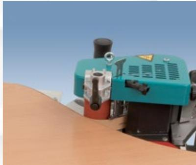
Einfaches Aufleimen von geformten und runden Platten.
