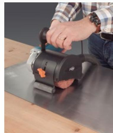
Verändern der Oberflächen durch Schleifen, Polieren und Strukturieren bei unterschiedlichen Werkstoffen.
