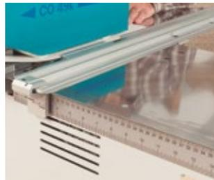
Die CO49K ist mit einem verstellbaren Anschlag und einer Scala ausgerüstet.
