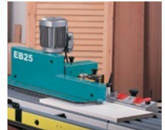
Vorschub-Einheit. Zuführung des zu bearbeitenden Werkstückes.
