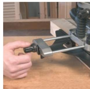
Mit seitlichem fein verstellbarem Werkstückanschlag.
