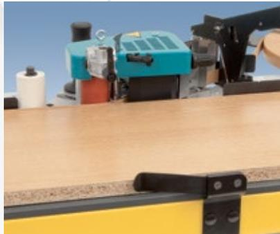
Frontführung ermöglicht stabile Arbeit.
