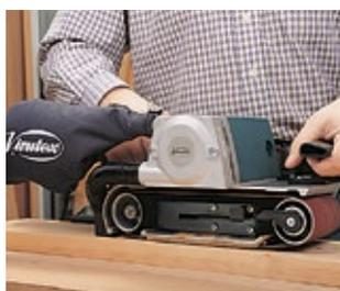
Mod. Nr. LB31EA inkl. eingebautem Staubsackvorrichtung.
