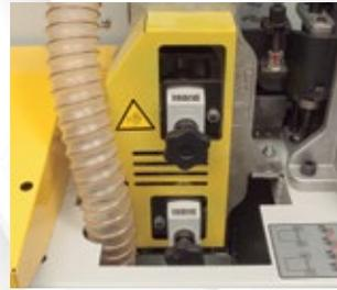
Direkte Einstellung der Fräs- und Kopiereinheit mittels verstellbaren Knopf mit Maßanzeige.
