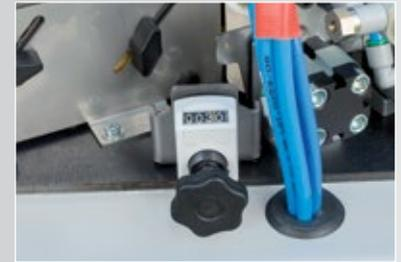
Gleichzeitiges Einstellen der Kantenstärke, des Einfuhrlineals und der Leimrolle mit 1 Digitalzähler.
