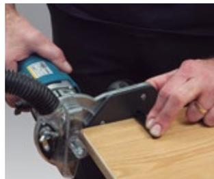
Absaugungsanschluss mit integrierter Lagerbremse, damit keine Beschädigung an der Kante erfolgen kann.
