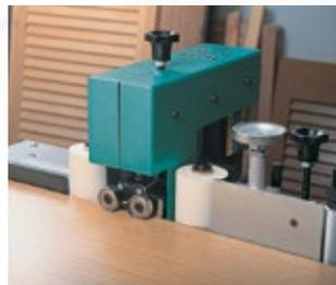
Kantenfräseinheit: Fräst das Band an beiden Seiten gleichzeitig.
