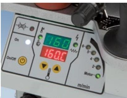
Temperaturregelung (120 bis 200° C) gesteuert durch Mikroprozessor für größere Genauigkeit. Temperaturregelung im Impulsbetrieb. Schützt die Heizelemente und verlängert so ihre Lebensdauer.
