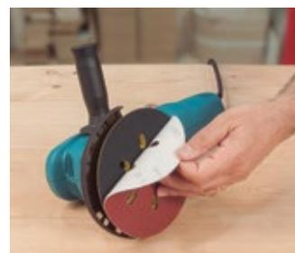
Absauglöcher für den Einsatz von Standardschleifscheiben.
