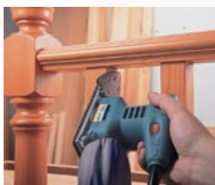
Durch den Einsatz des Delta-Aufsatzes sind schwer zugängliche Innenkanten und Blenden schnell und leicht zu schleifen.
