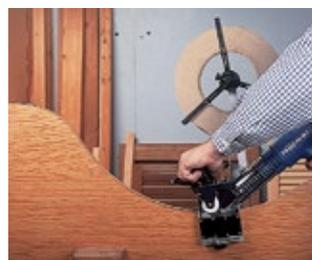
Möglichkeit der Kantenanleimung von geraden, kreisförmigen oder anderen Werkstücksformen.
