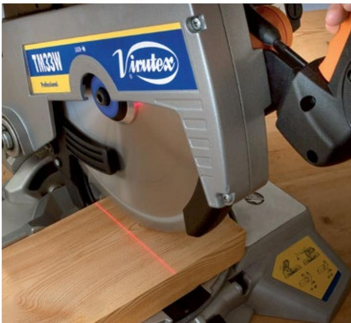
Ausgerüstet mit einem Präzisionslaser zum Führen des Schnitts. Automatisches Einschalten beim Starten der Maschine. Mit Ein-Ausschalter zum Abschalten beim Arbeiten am oberen Tisch. Die Laservorrichtung ist direkt auf der Sägeblattklemmmutter montiert, so dass der Laserstrahl in jeder Schnittposition seine Präzision behält.
