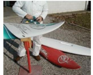
Schleifen von Materialien unterschiedlicher Härte und Struktur.
