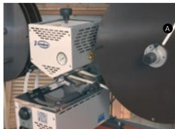
2545628 DV25P Automatische Wickelvorrichtung. Set zum Umbau der manuellen PR25VJ zu einer automatischen PR25VJ-DV.
