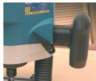
Hebel zum Festklemmen des Fräskopfes, vom Handgriff aus bedienbar.
