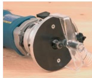
Der Fräskopf hat einen Absauganschluss, eine Lagerbremse und wird außerdem mit 3 Gleitplatten mit verschiedenen Bohrungen (d = 30 mm) geliefert.
