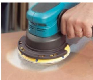
Das DUAL MODE System ermöglicht grobes und feines Schleifen.
