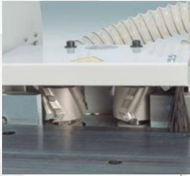
Motorisierte 2. Anpressrolle für ein besseres Andrücken der Kante an das Werkstück. Patentiertes System für ein saubere Leimfuge auch am Plattenanfang.
