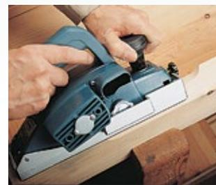
Speziell entwickelt zum Anfasen von Kanten.
