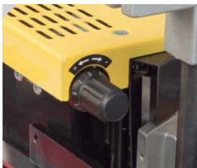
Mit Hilfe der Einstellung auf der Maschine und der genauen Kontrolle der Leimdosierung passt sich der Leimauftrag korrekt an die unterschiedlichen Materialien an.
