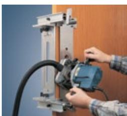
Seitliche Ausfräsungen für den Griff, Zylinder oder andere Beschläge.
