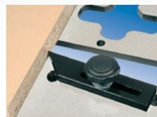
Verstellbarer Endanschlag für eine korrekte Positionierung. Ermöglicht das Korrigieren des Winkels zwischen der Wand und der Arbeitsplatte.
