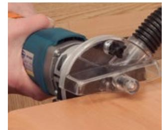
Rundkopf (V3) im Set enthalten. Sehr praktisch für das Fräsen mit Abstützung an den Kanten und unverzichtbar für Arbeitsaufträge, die diese Art von Arbeit beinhalten.
